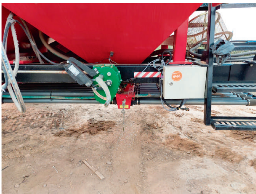
Установка линейного электроактуатора на редуктор посевного комплекса FEAT, при дифференцированном способе внесения минеральных удобрений
